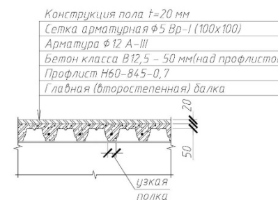
Состав монолитного перекрытия Floor – 50(M1:20)
